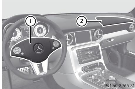
Le coussin gonflable du conducteur ① se déploie devant le volant de direction; le coussin gonflable avant du passager avant ② se déploie devant et au-dessus de la boîte à gants. Ils se déploient:
