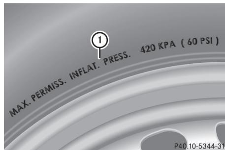
① Pression maximale sur les pneus (exemple)
