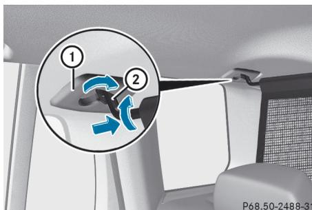
Filet cloison fixé derrière le montant C
