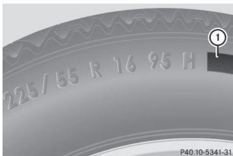
En plus de l'indice de charge, un code de charge ① peut être inscrit sur le flanc du pneu, après la lettre indiquant l'indice de vitesse ⑥ (> page 281).
