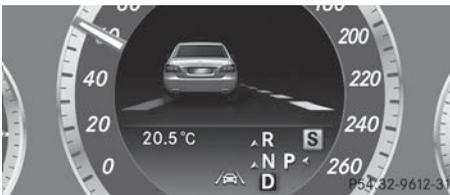
Lorsqu'une intervention de freinage permettant de revenir sur la voie empruntée a lieu, l'affichage représenté sur l'illustration apparaît sur le visuel multifonction.
