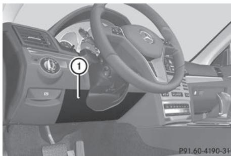
L'airbag de genoux côté conducteur ① se déploie en dessous de la colonne de direction. Il se déclenche en même temps que les airbags frontaux. L'airbag de genoux côté conducteur est conçu pour agir en combinaison avec les airbags frontaux lorsqu'une certaine valeur seuil est dépassée en cas de collision frontale. L'airbag de genoux côté con-
