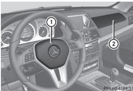
L'airbag frontal du conducteur ① se déploie devant le volant, l'airbag frontal du passager ② devant et au-dessus de la boîte à gants.
