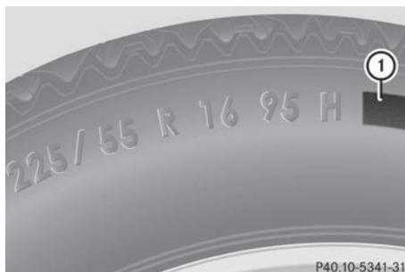
En plus de l'indice de charge, un code de charge ① peut être inscrit sur le flanc du pneu, après la lettre indiquant l'indice de vitesse ⑥ (▷ page 324).
