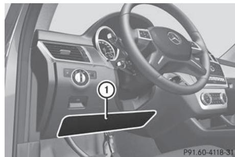
L'airbag de genoux côté conducteur ① se déploie en dessous de la colonne de direction. L'airbag de genoux côté conducteur se déclenche en même temps que les airbags frontaux. L'airbag de genoux côté conducteur est conçu pour agir en combinaison avec les airbags frontaux lorsqu'une certaine valeur seuil est dépassée en cas de collision frontale. L'airbag de genoux côté conducteur assure sa protection au mieux en liaison avec
