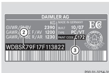
Plaque constructeur du véhicule (exemple)
