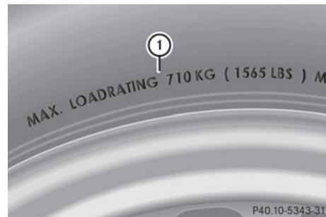
La charge maximale du pneu ① correspond au poids maximal pour lequel un pneu a été homologué.
