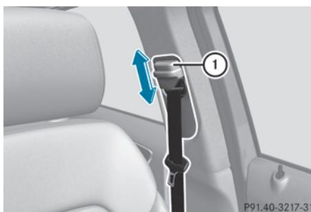
Le réglage en hauteur de la ceinture de sécurité est possible au niveau des sièges avant. Réglez la hauteur de la ceinture de sécurité de manière à ce que la partie supérieure de la ceinture passe sur l'épaule.
