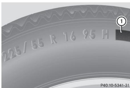
En plus de l'indice de charge, un code de charge ① peut être inscrit sur le flanc du pneu, après la lettre indiquant l'indice de vitesse ⑥ (▷ page 366).
