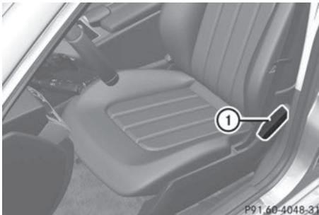
Les airbags bassin ① augmentent, en cas de déclenchement, le potentiel de protection des occupants du côté où se produit le choc.
