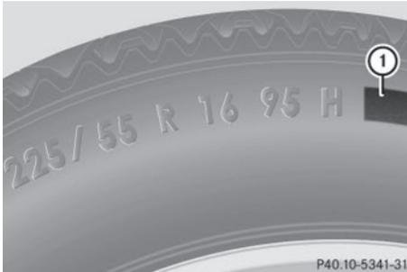
En plus de l'indice de charge, un code de charge ① peut être inscrit sur le flanc du pneu, après la lettre indiquant l'indice de vitesse ⑥ (▷ page 276).
