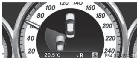
Si l'avertisseur actif d'angle mort détecte un risque de collision latérale dans la zone de surveillance, il déclenche une intervention de freinage permettant de corriger la trajectoire. Celle-ci a pour but de vous aider à éviter une collision.
