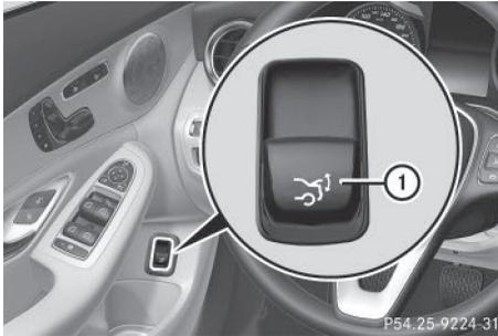
Lorsque le véhicule est à l'arrêt et déverrouillé, vous pouvez ouvrir le coffre depuis le siège du conducteur.
