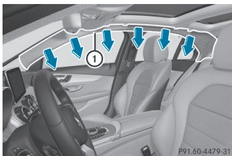
Les airbags rideaux ① sont montés sur les côtés du cadre du toit et se déploient du montant A au montant C.
