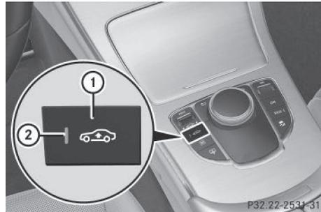
En dessous de 50 mph (80 km/h), vous pouvez choisir entre les niveaux « Normal » et « Surélevé ». Sélectionnez le niveau « Normal » lorsque les conditions routières sont normales et « Surélevé » pour rouler avec des chaînes neige ou lorsque les conditions routières sont mauvaises. Votre réglage reste mémorisé même si vous retirez la clé du contacteur d'allumage.
