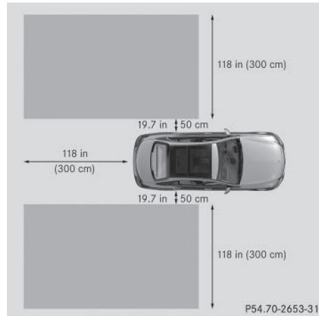
La zone surveillée par l'avertisseur d'angle mort est représentée sur l'illustration. Elle s'étend jusqu'à 10 ft (3 m) derrière le véhicule et sur les côtés.
