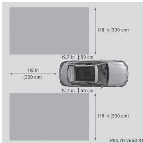
La zone surveillée par l'avertisseur actif d'angle mort est représentée sur l'illustration. Elle s'étend jusqu'à 10 ft (3,0 m) derrière le véhicule et sur les côtés.
