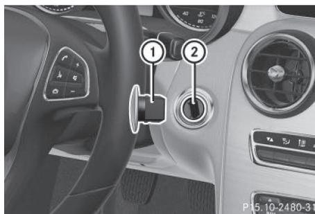
Lorsque vous introduisez la touche de démarrage et d'arrêt ① dans le contacteur d'allumage ②, le système a besoin d'un temps de reconnaissance de 2 secondes. Vous pouvez ensuite utiliser la touche de démarrage et d'arrêt ①.
