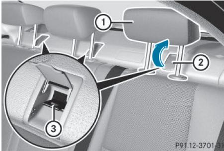
Les points d'ancrage Top Tether (3) sont montés à l'arrière, derrière les appuie-tête sur la plage arrière.
