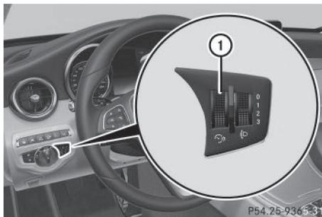
Le variateur de luminosité ① vous permet de régler l'éclairage du combiné d'instruments,
