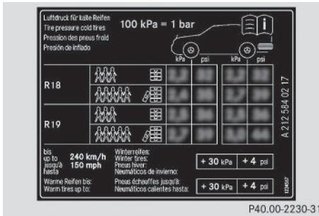
Certains tableaux des pressions de gonflage des pneus mentionnent uniquement le diamètre des jantes (**R18**, par exemple) à la place des dimensions de pneus complètes. Le diamètre des jantes est indiqué dans les dimensions des pneus et figure sur le flanc des pneus (▷ page 312).
