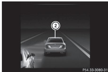
Lorsqu'une intervention de freinage permettant de corriger la trajectoire a lieu, le voyant rouge d'alerte ① intégré au rétroviseur extérieur clignote et un double signal d'alerte retentit. En outre, un affichage ② signalant un risque de collision latérale apparaît sur le visuel multifonction.
