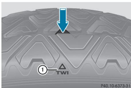
Un indicateur ① d'usure de la bande de roulement se présente sous la forme d'une barrette intégrée dans les sculptures du pneu.
