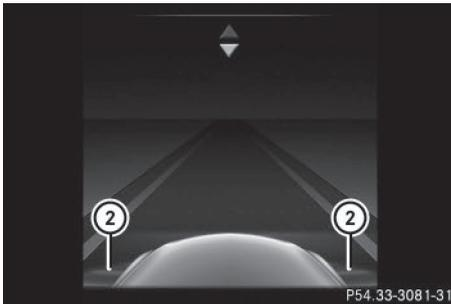
Si l'avertisseur actif d'angle mort est activé, des ondes radar grises se propageant vers l'arrière apparaissent à côté du véhicule sur le graphique du système d'aide du visuel multifonction. Lorsque vous roulez à plus de 20 mph (30 km/h), les ondes radar deviennent vertes sur le graphique du système d'aide ②. L'avertisseur actif d'angle mort est alors opérationnel.
