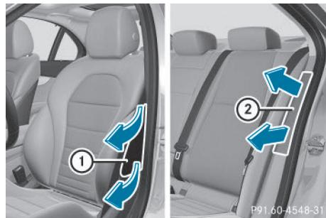
Les airbags latéraux avant ① et les airbags latéraux arrière ② se déploient au niveau des joues extérieures du dossier.
