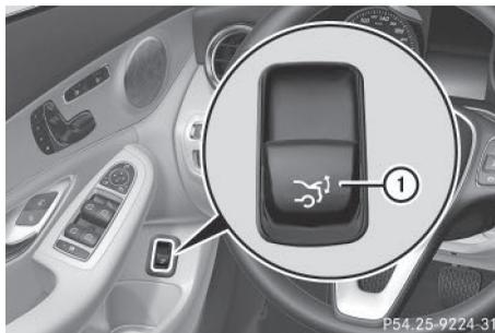
Lorsque le véhicule est à l'arrêt et déverrouillé, vous pouvez ouvrir et fermer le coffre depuis le siège du conducteur.
