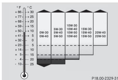
La viscosité désigne la fluidité d'un liquide. Dans le cas de l'huile moteur, une viscosité
