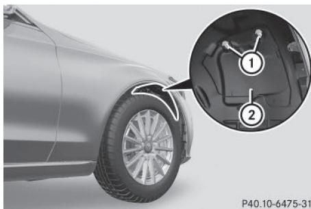
Avant de pouvoir remplacer l'ampoule du clignotant avant, vous devez déposer le cache qui se trouve dans le passage de roue avant.
