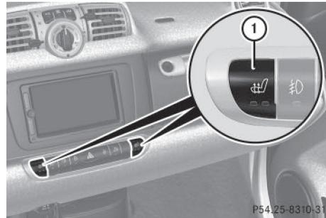
Le chauffage des sièges a deux degrés. Les témoins sur le commutateur du chauffage des sièges ① s'allument pour indiquer le niveau de chauffage sélectionné.
