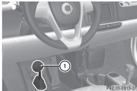
En cas de défectuosité d'un circuit de freinage (> page 181), il faut appuyer plus à fond sur la pédale de frein **1** pour obtenir le même effet, et la distance de freinage augmente.
