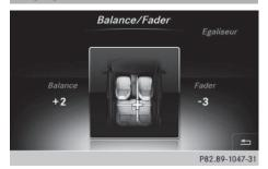
La balance adapte le volume sonore du côté gauche et du côté droit. Le fader adapte le volume sonore à l'avant et à l'arrière.
