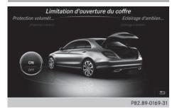
L'activation de la fonction Limitation d'ouverture du coffre permet d'éviter que le couvercle de coffre ne heurte le plafond du garage par exemple, si celui-ci est bas. L'option de réglage par l'intermédiaire de COMAND Online est disponible uniquement sur la berline Classe C.
