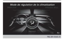
Le réglage du mode de régulation de la climatisation détermine le flux d'air. Le réglage est actif lorsque le climatiseur est réglé sur **AUTO** (voir la notice d'utilisation du véhicule).
