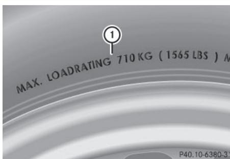
La charge maximale du pneu **1** correspond au poids maximal pour lequel un pneu a été homologué.
