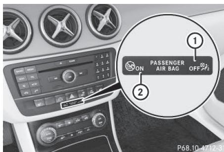
Les voyants PASSENGER AIR BAG OFF ① et PASSENGER AIR BAG ON ② font partie du système de classification des occupants (OCS).
