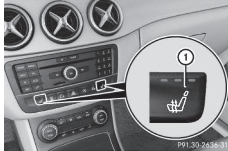
Les 3 voyants rouges incorporés à la touche indiquent le niveau de chauffage sélectionné. Le chauffage passe automatiquement du niveau **3** au niveau **2** au bout de 8 minutes environ. Le chauffage passe automatiquement du niveau **2** au niveau **1** au bout de 10 minutes environ. Sur le niveau **1**, le chauffage s'arrête automatiquement au bout de 20 minutes environ.
