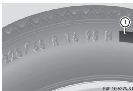
En plus de l'indice de charge, un code de charge **1** peut être inscrit sur le flanc du pneu, après la lettre indiquant l'indice de vitesse. Indice de vitesse (▷ page 243)
