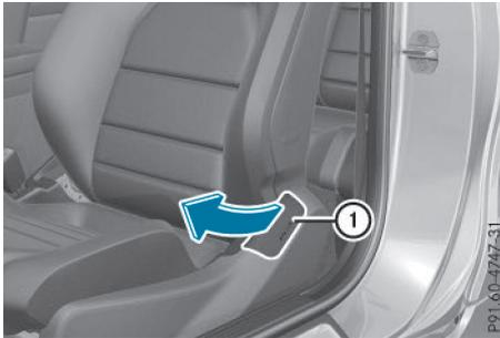
Les airbags bassin ① se déploient au niveau de la partie inférieure des joues extérieures des sièges.
