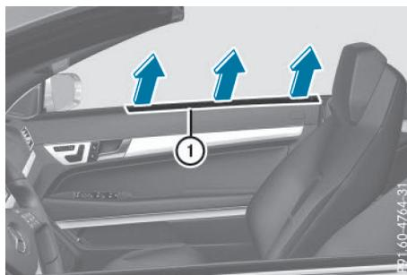
Les airbags tête ① se déploient au niveau des vitres latérales avant.
