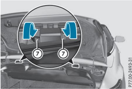
Les charnières du compartiment de capote se trouvent à gauche et à droite dans l'interstice entre le couvercle du compartiment de capote et le joint du coffre.
