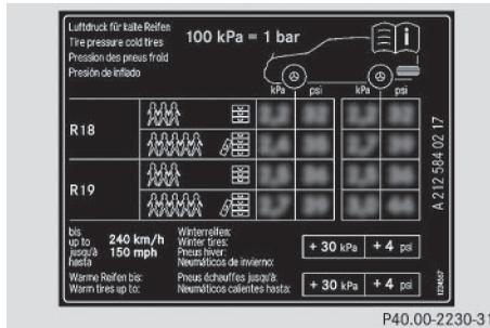
Certains tableaux des pressions de gonflage des pneus mentionnent uniquement le diamètre des jantes (**R18**, par exemple) à la place des dimensions de pneus complètes. Le diamètre des jantes est indiqué dans les dimensions des pneus et figure sur le flanc des pneus (▷ page 315).
