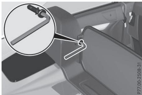
Vis sur le filet pare-vent AIRCAP situé entre les appuie-tête arrière
