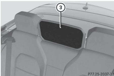
En même temps, les appuie-tête des sièges arrière et le filet pare-vent AIRCAP **③** se déplacent à mi-hauteur.
