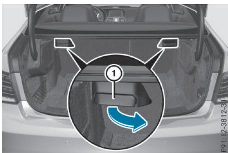
**i** Véhicules équipés de la fonction Mémoires : lorsque vous basculez l'un des dossiers arrière ou les 2 dossiers arrière vers l'avant, le ou les sièges avant correspondants s'avancent légèrement, si nécessaire, afin d'éviter une collision.
