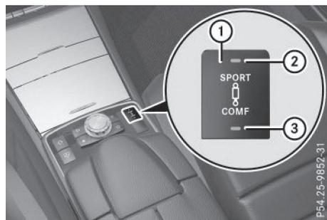
En mode de conduite Confort, la conduite de votre véhicule est plus confortable. Sélectionnez par conséquent ce mode si vous préférez une conduite confortable. Sélectionnez
