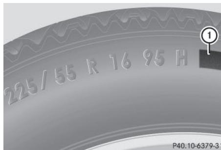
En plus de l'indice de charge, un code de charge ① peut être inscrit sur le flanc du pneu, après la lettre indiquant l'indice de vitesse ⑥ (▷ page 315).
