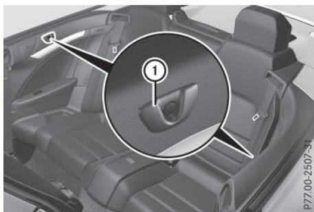
Le filet pare-vent vous protège du vent lorsque vous roulez avec la capote ouverte. Il est fixé au-dessus des sièges arrière. Par consé-
