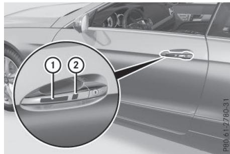
► **Déverrouillage du véhicule:** touchez le côté intérieur de la poignée.
