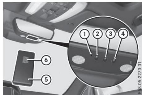
La télécommande ⑤ du système d'entraînement de la porte de garage n'est pas fournie avec le système de commande de porte de garage intégré.
