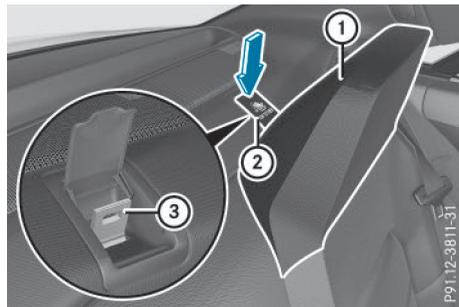
Les points d'ancrage Top Tether sont montés à l'arrière, derrière les appuie-tête.
