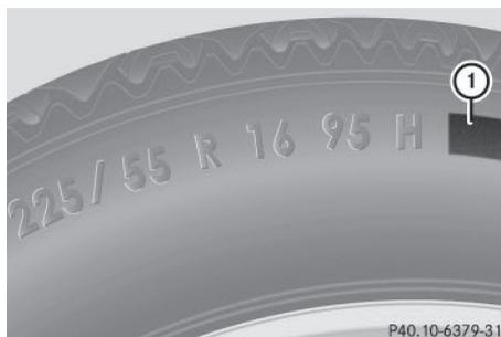
En plus de l'indice de charge, un code de charge ① peut être inscrit sur le flanc du pneu, après la lettre indiquant l'indice de vitesse. Indice de vitesse (▷ page 314)
