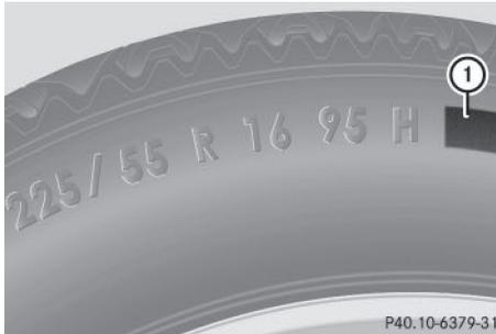
En plus de l'indice de charge, un code de charge ① peut être inscrit sur le flanc du pneu, après la lettre indiquant l'indice de vitesse ⑥ (▷ page 352).
