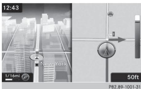
Avant et pendant une manœuvre, vous pouvez voir la carte dans la partie gauche du visuel et une vue des carrefours ou une image en 3D dans la partie droite. Si la route comporte plusieurs voies de circulation, le système peut afficher sur le bord inférieur du visuel une recommandation (flèche de direction blanche) concernant la voie de circulation à emprunter.
