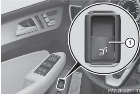
Lorsque le véhicule est à l'arrêt et déverrouillé, vous pouvez ouvrir et fermer le hayon depuis le siège du conducteur.
