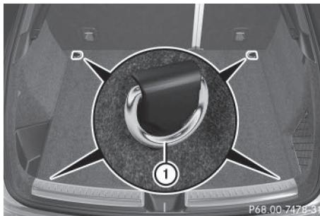
4 anneaux d'arrimage ① sont disposés dans le compartiment de chargement.
