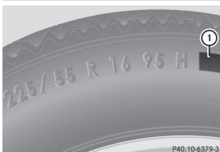
En plus de l'indice de charge, un code de charge ① peut être inscrit sur le flanc du pneu, après la lettre indiquant l'indice de vitesse ⑥ (> page 323).
