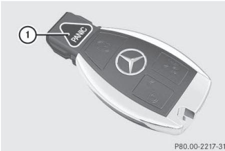
► **Activation:** appuyez sur la touche **PANIC** ① pendant 1 seconde environ. Lorsque le système d'alarme est activé, une alarme optique et une alarme acoustique se déclenchent.
