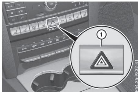
► **Allumage et extinction des feux de détresse:** appuyez sur la touche ①. Lorsque les feux de détresse sont allumés, tous les clignotants s'allument. Si vous allumez les clignotants d'un côté du véhicule par l'intermédiaire du commodo, seuls les clignotants de ce côté du véhicule clignotent.
