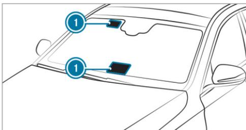
Le pare-brise est recouvert d'une couche réfléchissant les infrarouges qui empêche une forte montée en température dans l'habitacle.
