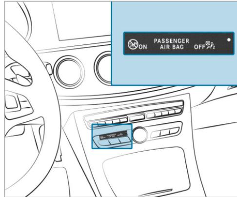
Lorsque le contact est mis, les 2 voyants PASSENGER AIR BAG ON et OFF s'allument pendant l'autodiagnostic du système.
