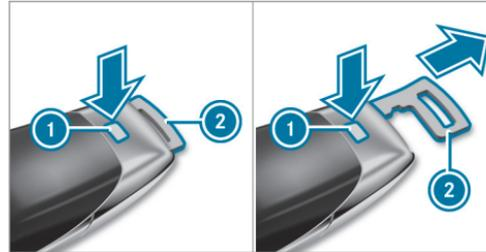
▶ **Retrait** : appuyez sur le bouton de déverrouillage ①. La clé de secours ② glisse légèrement vers l'extérieur.
