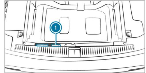
L'anneau de remorquage ① est fixé sous le plancher du compartiment de chargement, au bord du compartiment de chargement.
