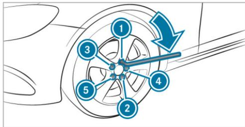
▶ Serrez les vis de roue uniformément dans l'ordre indiqué ① à ⑤, c'est-à-dire en diagonale.
