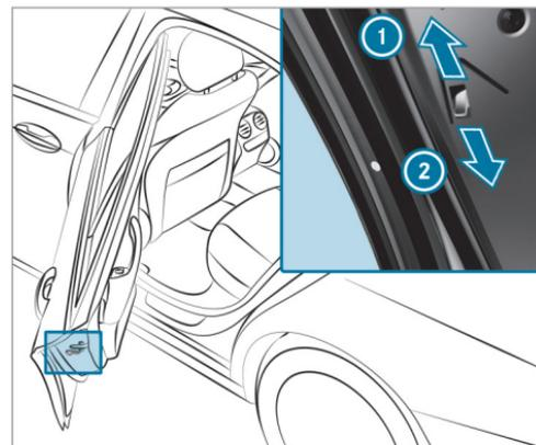
▶ Actionnez le levier dans le sens de la flèche **1 (activation de la sécurité)** ou **2 (désactivation de la sécurité)**.
