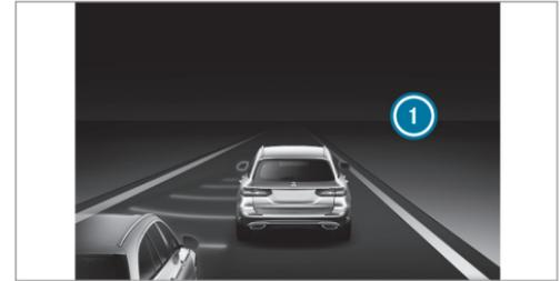
Lorsqu'une intervention de freinage permettant de corriger la trajectoire a lieu, le voyant rouge d'alerte intégré au rétroviseur extérieur clignote
