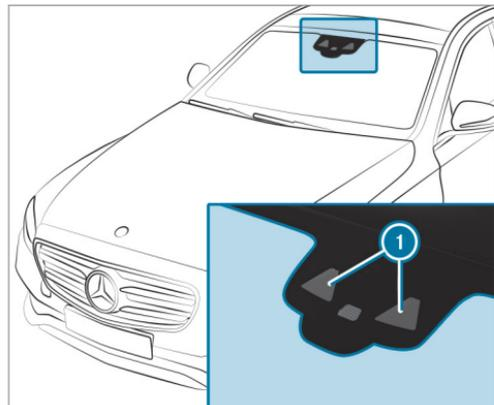
L'assistant de signalisation routière détecte les panneaux à l'aide d'une caméra multifonction ① et vous aide en affichant les limites de vitesse et interdictions de dépasser détectées sur le combiné d'instruments. Les panneaux de
