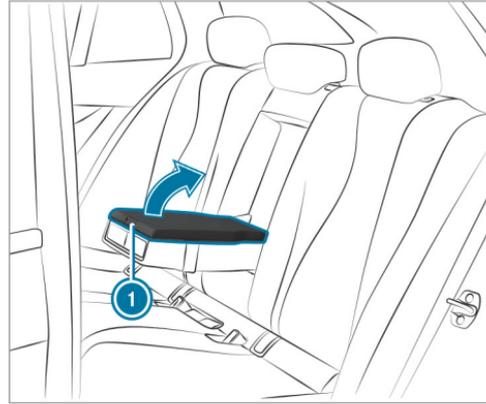
► **Ouverture** : appuyez sur le bouton de déverrouillage ① situé à l'avant du cache de l'accoudoir, puis relevez-le.
