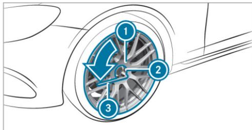
► **Dépose** : posez l'embout enfichable ② sur le cache-moyeu ①.
