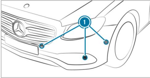
L'aide au stationnement PARKTRONIC est un système électronique qui fonctionne avec des ultrasons. Elle surveille les environs du véhicule avec 6 capteurs ❶ dans le pare-chocs avant et 6 capteurs dans le pare-chocs arrière. L'aide au stationnement PARKTRONIC vous indique de manière optique et sonore la distance qui sépare le véhicule d'un obstacle.
