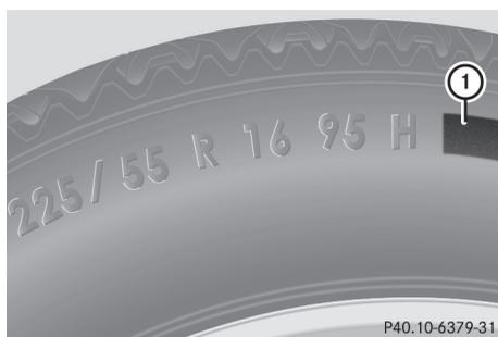
En plus de l'indice de charge, un code de charge **1** peut être inscrit sur le flanc du pneu, après la lettre indiquant l'indice de vitesse. Indice de vitesse (> page 336)
