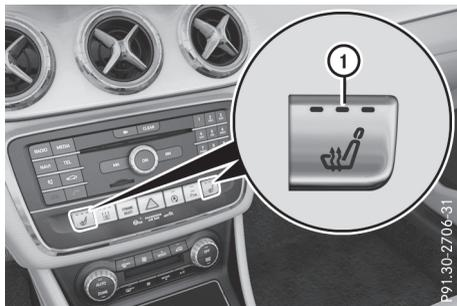
Les 3 voyants rouges incorporés à la touche indiquent le niveau de chauffage sélectionné.
