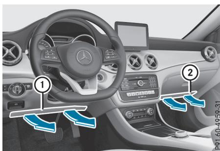
L'airbag de genoux côté conducteur ① se déploie en dessous de la colonne de direction et l'airbag de genoux côté passager ② en dessous de la boîte à gants. Les airbags de genoux côté conducteur et côté passager se déclenchent en même temps que les airbags frontaux.
