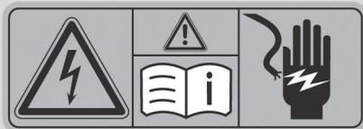
Tous les composants du réseau de bord haute tension sont dotés d'étiquettes d'avertissement autocollantes jaunes qui vous mettent en garde contre les dangers liés au système haute tension. Les câbles du réseau de bord haute tension sont de couleur orange.
