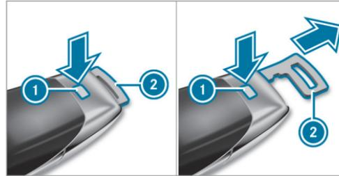
▶ **Retrait :** appuyez sur le bouton de déverrouillage **1**. La clé de secours **2** glisse légèrement vers l'extérieur.
