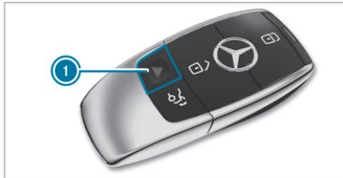
▶ **Activation** : appuyez sur la touche ❶ pendant 1 seconde environ. Une alarme optique et une alarme sonore se déclenchent.
