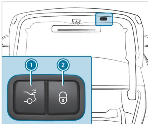
▶ **Véhicules équipés de la fermeture confort du couvercle de coffre** : appuyez sur la touche de fermeture
