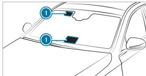
Le pare-brise est recouvert d'une couche réfléchissant les infrarouges qui atténue la montée en température dans l'habitacle.
