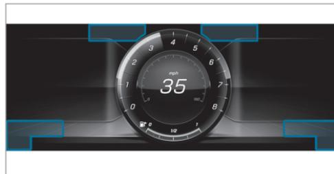
Si vous sélectionnez le réglage d'écran Progressive sur les véhicules équipés d'un poste de conduite Widescreen, la position des voyants qui se trouvent sur l'écran pour les instruments change.
