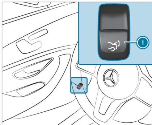
▶ **Véhicules équipés de la fermeture confort du couvercle de coffre** : appuyez sur la touche de commande à distance du couvercle de coffre
