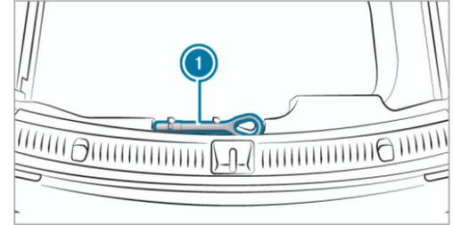
L'anneau de remorquage ① est fixé sous le plancher du coffre, au bord du coffre.
