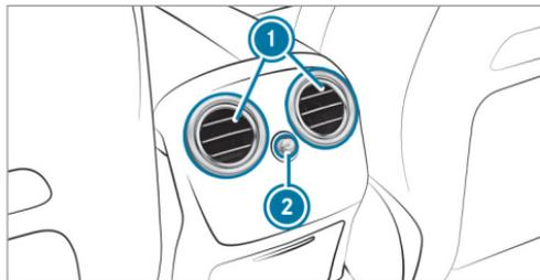
► **Ouverture et fermeture** : tournez la molette de réglage ② vers la droite ou vers la gauche jusqu'en butée.
