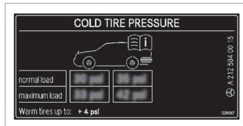
Le tableau de pression des pneus indique la pression de pneu recommandée pour tous les pneus homologués pour ce véhicule et montés d'usine. Les pressions de pneu recommandées sont valables pour des pneus froids pour diffé-
