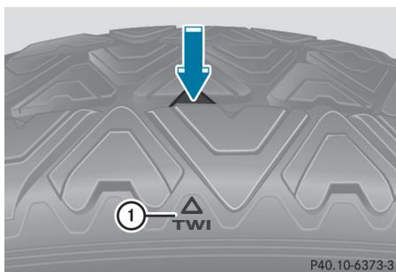
Le repère ① indique l'emplacement auquel l'indicateur (flèche) d'usure de la bande de roulement, qui se présente sous la forme d'une barrette, est intégré dans les sculptures du pneu. Les indicateurs d'usure de la bande de roulement sont prescrits par la loi. Les indicateurs
