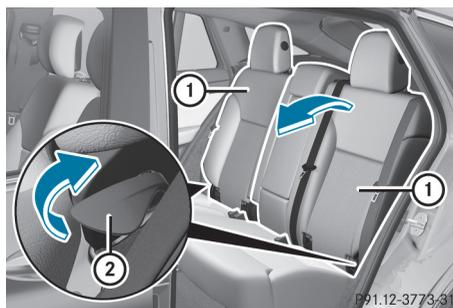
Vous pouvez régler l'inclinaison des dossiers des sièges de la 2e rangée. Plusieurs positions de verrouillage sont possibles.
