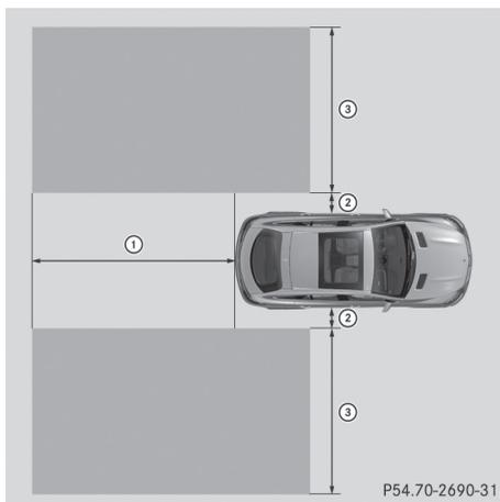
L'avertisseur actif d'angle mort surveille à une distance d'environ 1,6 ft (0,5 m) (2) du véhicule la zone représentée sur l'illustration qui s'étend jusqu'à 10 ft (3 m) sur les côtés (3) et derrière (1) votre véhicule.
