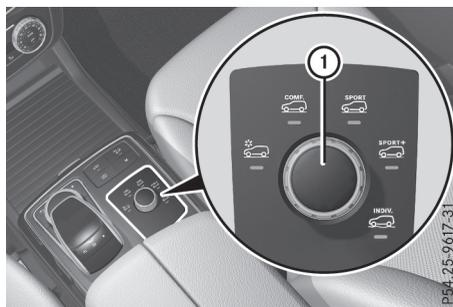
Dans le programme de conduite **Sport Plus**, le réglage très ferme de la suspension permet un contact optimal avec la chaussée. Sélectionnez ce mode pour une conduite énergique, par exemple sur des routes de campagne sinueuses ou de préférence sur des circuits délimités.
