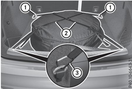
Extraction de la roue de secours compacte
