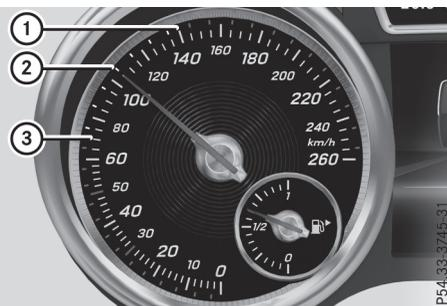
Affichage de l'assistant de régulation de distance DISTRONIC actif sur le tachymètre (exemple)
