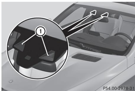
L'assistant de régulation de distance DISTRONIC actif avec direction active vous aide à conduire au milieu de la voie par de légers braquages dans une plage de vitesse située entre 0 et 125 mph (0 et 200 km/h).
