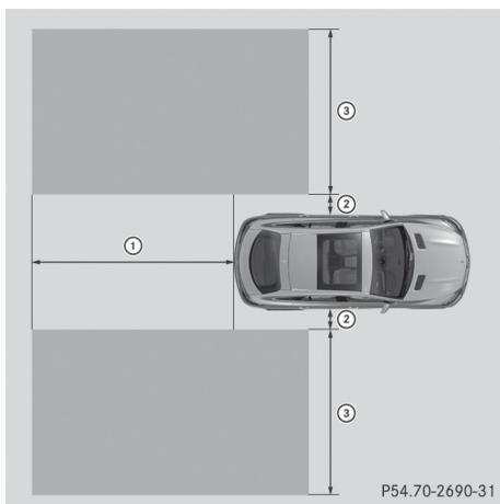
L'avertisseur d'angle mort surveille à une distance d'environ 1,6 ft (0,5 m) ② du véhicule la zone représentée sur l'illustration qui s'étend jusqu'à 10 ft (3 m) sur les côtés ③ et derrière ① votre véhicule.
