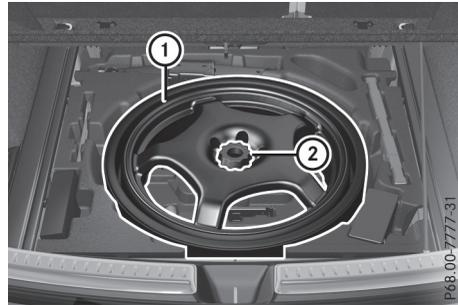
Extraction de la roue de secours compacte
