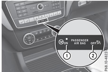
Les voyants PASSENGER AIR BAG ON ① et PASSENGER AIR BAG OFF ② font partie du système de classification des occupants (OCS).
