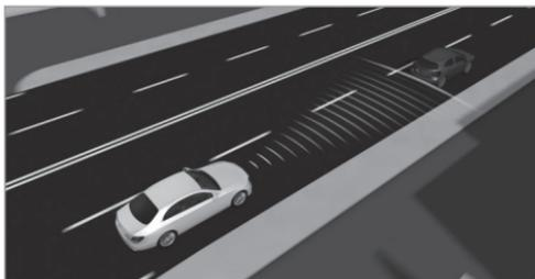
L'assistant de régulation de distance DISTRONIC actif maintient la vitesse réglée en cas de trafic fluide. En cas de véhicules qui précèdent détectés, la distance réglée est maintenue, si nécessaire jusqu'à l'arrêt complet. Le véhicule accélère ou ralentit en fonction de la distance par rapport au véhicule qui précède et de la vitesse réglée. La vitesse (comprise entre 15 mph (20 km/h) et 130 mph (210 km/h)) et la distance sont réglées et mémorisées sur le volant.
