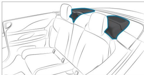
Les arceaux de sécurité se trouvent sous les caches situés derrière les appuie-tête arrière. Les arceaux de sécurité se déclenchent lorsqu'un risque de retournement du véhicule est détecté.
