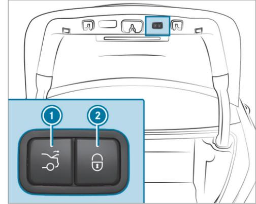
▶ **Véhicules équipés de la fermeture confort du couvercle de coffre :** appuyez sur la touche de fermeture ① qui se trouve sur le couvercle de coffre.
