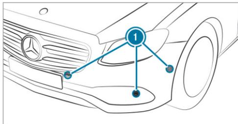
L'assistant de stationnement PARKTRONIC est une aide au stationnement électronique qui fonctionne avec des ultrasons. Il surveille les environs du véhicule avec 6 capteurs ① dans le pare-chocs avant et 6 capteurs dans le pare-chocs arrière. L'assistant de stationnement PARKTRONIC vous indique de manière optique et sonore la distance qui sépare le véhicule d'un obstacle.
