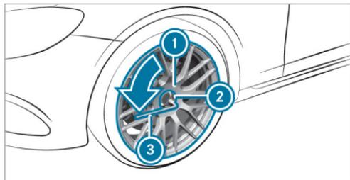
► **Dépose** : posez l'embout enfichable (2) sur le cache-moyeu (1).
