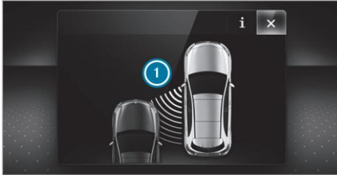
Lorsqu'une intervention de freinage permettant de corriger la trajectoire a lieu, le voyant rouge d'alerte intégré au rétroviseur extérieur clignote et un signal d'alerte retentit. En outre, un affichage ❶ signalant un risque de collision latérale apparaît sur l'écran multifonction.
