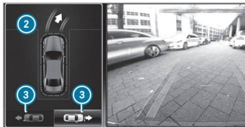
▶ Si le véhicule a été garé perpendiculairement au sens de la marche: sélectionnez dans la zone ② la direction que vous devez prendre pour sortir de la place de stationnement ③.
