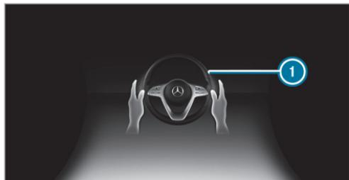
Lorsque le conducteur ne dirige pas lui-même le véhicule ou lâche le volant pendant une période prolongée, une alerte optique se déclenche d'abord. L'affichage ❶ apparaît sur l'écran multifonction. Si le conducteur ne dirige toujours pas activement le véhicule ou ne donne pas de signal de confirmation au système, un signal d'alerte retentit de façon répétée en plus de l'alerte optique.
