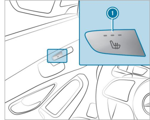
▶ **Mise en marche/augmentation de la puissance** : appuyez sur la touche ① autant de fois qu'il est nécessaire pour atteindre le niveau de chauffage souhaité.
