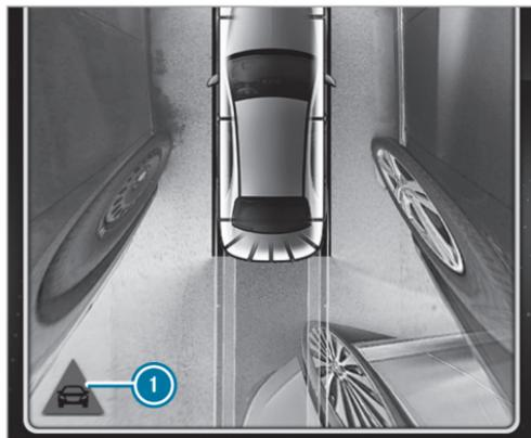
**Véhicules équipés de l'assistant d'angle mort** : la fonction Cross Traffic Alert peut vous avertir des véhicules circulant sur les voies transversales lorsque vous sortez d'une place de stationnement en marche arrière. Pour ce faire, les capteurs radar situés dans le pare-chocs surveillent la zone adjacente au véhicule. Lorsqu'une situation critique est détectée, le symbole ❶ apparaît sur l'écran média. Si le conduc-
