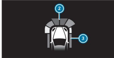
Les obstacles détectés par l'assistant de stationnement PARKTRONIC se trouvant à moins de 3,3 ft (1,0 m) environ à l'avant ② et 2,2 ft (0,7 m) environ sur les côtés ③ peuvent, en option, également apparaître dans l'affichage tête haute.
