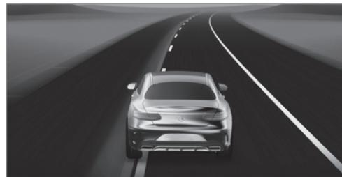
Si vous franchissez une ligne de délimitation de la voie détectée avec une roue avant, celle-ci est mise en évidence en rouge dans le menu **Assistance** sur l'écran conducteur.
