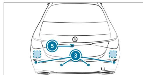
❶ Les capteurs radar et lidar sont intégrés derrière les pare-chocs et/ou derrière l'étoile Mercedes.
