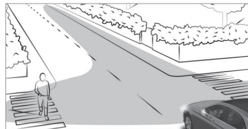
L'éclairage d'intersection augmente considérablement l'angle d'éclairage de la chaussée qu'emprunte le véhicule et permet ainsi de mieux repérer les virages serrés, par exemple. Il peut uniquement être activé lorsque les feux de croisement sont allumés.
