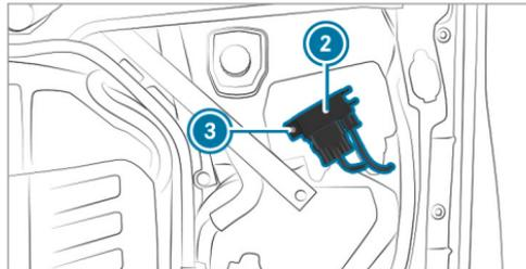
▶ Selon l'équipement du véhicule, un composant électrique **2** se trouve sur le couvercle de la boîte à fusibles. Le cas échéant, desserrez la vis **3** et mettez le composant de côté sans débrancher les connecteurs électriques.
