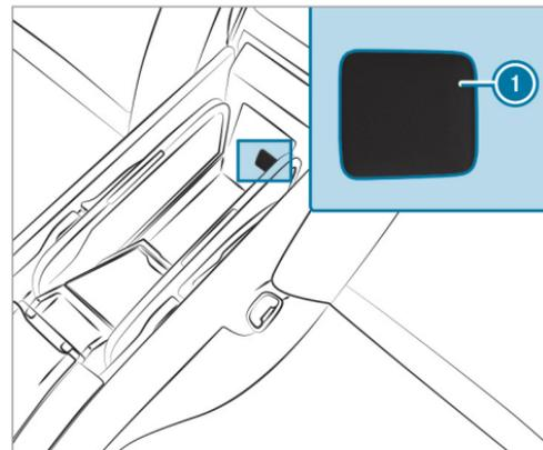
Prise 12 V dans la console centrale arrière (exemple)
