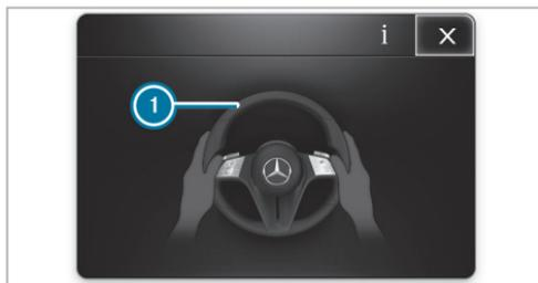
Si le système détecte que le conducteur ne dirige pas lui-même le véhicule ou qu'il lâche le volant pendant une période prolongée, une alerte optique ① se déclenche. Si le conducteur ne dirige toujours pas activement le véhicule ou ne donne pas de signal de confirmation au système, un signal d'alerte retentit de façon répétée en plus de l'alerte optique.
