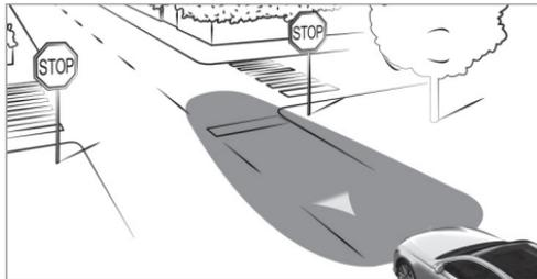
Lorsque l'assistant de signalisation routière détecte une situation correspondante, à une vitesse égale ou supérieure à 30 km/h, un triangle est projeté sur la chaussée dans les situations suivantes:
