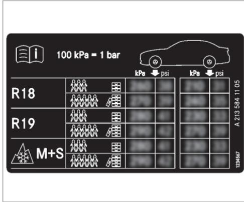
Certains tableaux de pression des pneus mentionnent uniquement le diamètre des jantes (**R18**, par exemple) à la place des dimensions de pneus complètes. Le diamètre des jantes est indiqué dans les dimensions des pneus et figure sur le flanc des pneus (→ page 406).
