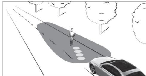
La fonction Spotlight fonctionne en arrière-plan et signale par quatre brefs clignotements des phares les personnes détectées à l'intérieur de la ligne de délimitation de la voie. Le conducteur est averti par une projection du symbole de la position de piétons venant en sens inverse.
