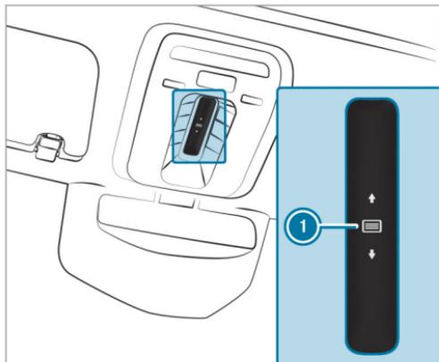
Le panneau de commande ❶ permet de commander le toit ouvrant et le store pare-soleil avant.
