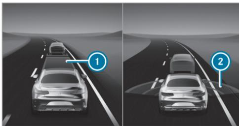
Dans le menu **Assistance**, une distance insuffisante ① par rapport au véhicule qui précède est représentée en rouge. Si vous réduisez la distance encore davantage, le véhicule qui précède est également affiché en rouge. Si un risque de collision est détecté, des ondes radar rouges ② apparaissent devant le véhicule.
