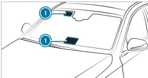
Les appareils commandés par radio, tels que les systèmes de télépéage, peuvent uniquement être montés dans les zones du pare-brise laissant passer les ondes radio ①.
