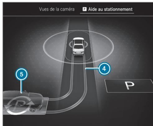
Lorsque le véhicule est à l'arrêt, la trajectoire visée ④ pour entrer dans la place de stationnement actuellement sélectionnée ⑤ est également affichée.
