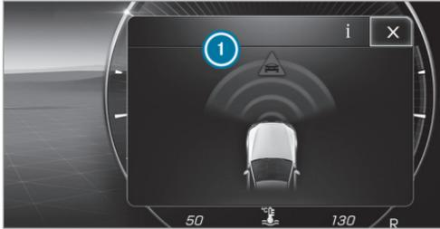
Lorsqu'un freinage autonome ou une assistance au freinage asservie à la situation a été déclenché, la fenêtre contextuelle ❶ apparaît sur l'écran conducteur, puis disparaît automatiquement après un court instant.
