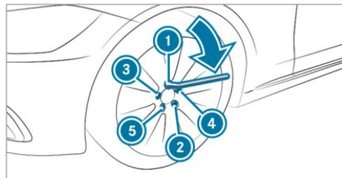
▶ Serrez les vis de roue uniformément dans l'ordre indiqué ① à ⑤, c'est-à-dire en diagonale, avec un couple maximal de 59 lb-ft (80 Nm) dans un premier temps.
