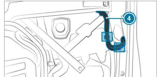
▶ Le cas échéant, détachez les flexibles **4** des agrafes de retenue au niveau de la boîte à fusibles et de la carrosserie.
