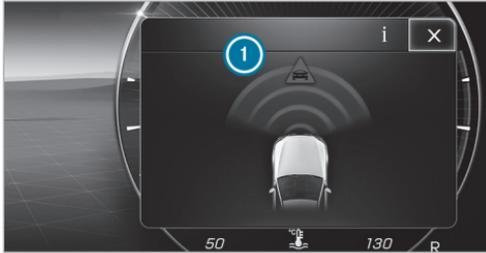
Lorsqu'un freinage autonome ou une amplification de la force de freinage asservie à la situation a été déclenché, la fenêtre contextuelle ① apparaît sur l'écran conducteur, puis disparaît automatiquement après un court instant.
